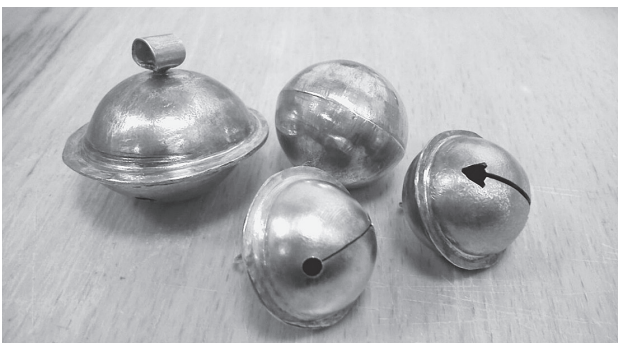
Abb. 5: Fertig verlötete, abgefeilte und polierte Schellen (Foto: Sophia Opel).
