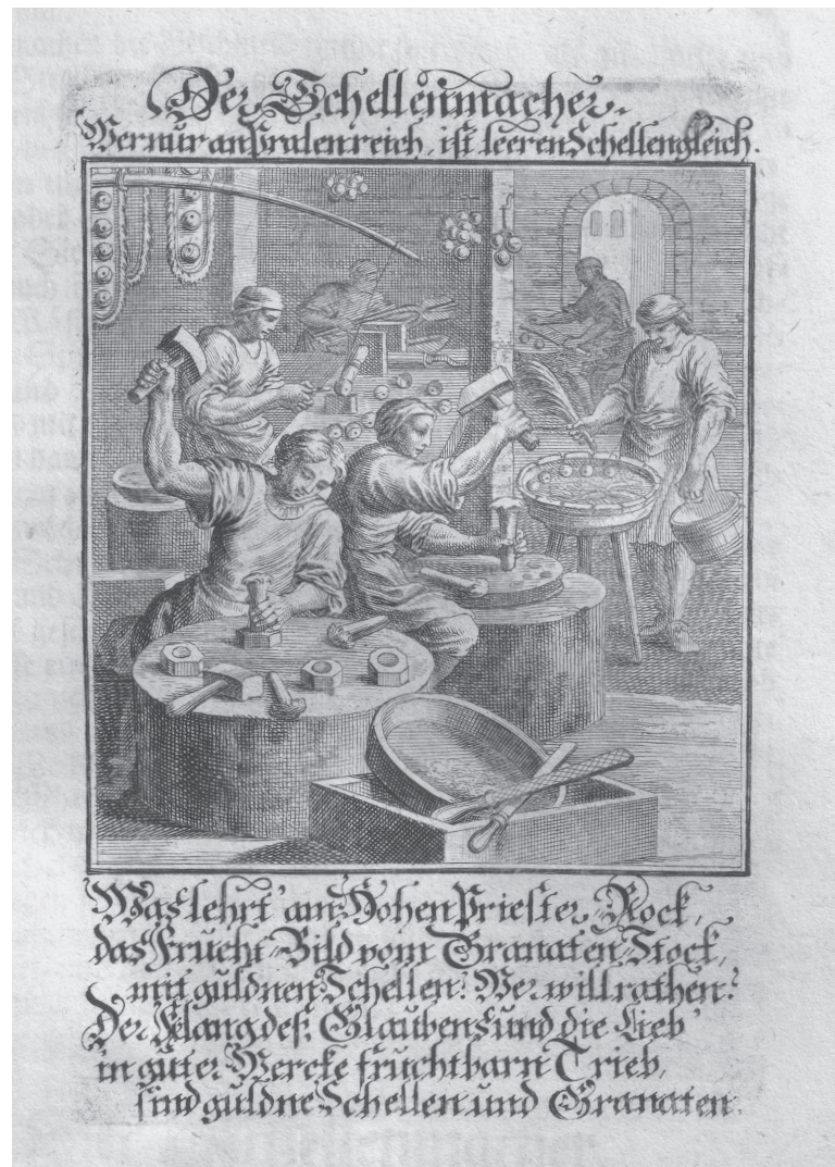
Abb. 3: Der Schellenmacher. In: Christoph Weigel d. Ä.: Abbildung und Beschreibung der gemeinnützlichen Hauptstände. Regensburg 1698, vor S. 341. Dargestellt sind das Abdrehen auf der Drehbank und das Herstellen der Halbschalen (Scan: GNM, Bibliothek).
