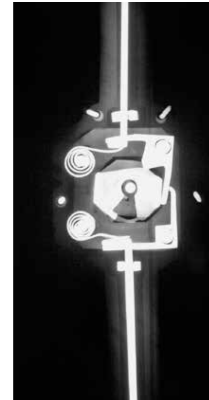
211 Röntgenbild vom Schloss der rechten Tür am Aufsatz von Kat. 1
