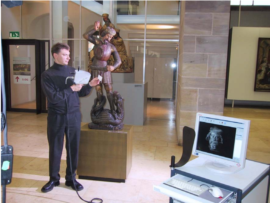
Abb. 1 Die Laservermessung der Georgsfigur durch die Fa. Steinbichler
