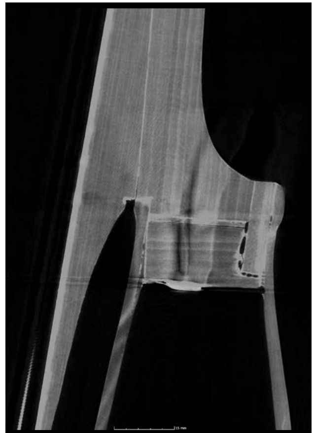
Abb. 4: Schnittbild am Halsansatz einer Geige (Inv. Nr. MI 419). Die später ausgeführte Reparatur wird sichtbar (Foto: Fraunhofer EZRT /GNM).
