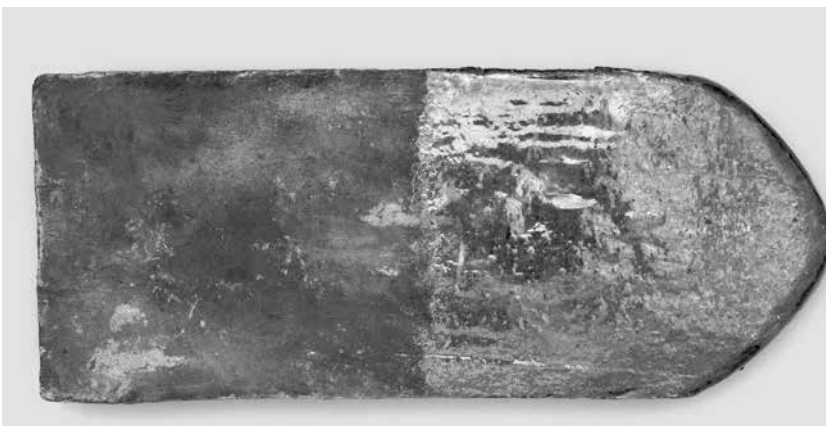
Abb. 9: Biberschwanz, Freiburg, um 1530, Ziegelton, teilweise braun glasiert, L. 31,3 cm, B. 12,8 cm, Inv.Nr. A 1526 (Foto: Monika Runge).
