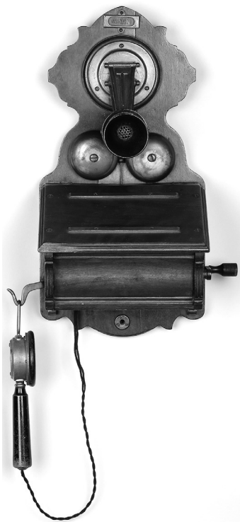
Abb. 1: Fernsprechapparat OB 04, Wandtelefon Siemens & Halske, 1904, Holz, Messing, vernickelt, Elektrotechnik, H. 47 cm, B. 32 cm, T. 19 cm (ohne herabhängenden Hörer), Hörer: 24,5 x 8 cm, Inv. Des1867 (Foto: Monika Runge).
